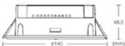
cut out: ø114 FFRLED2 FFRLEDBK2
